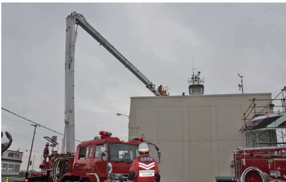
大型高所放水車による救助
